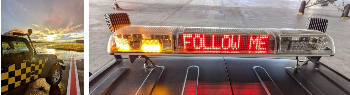
Die Bedienung des Warnlichtbalkens und des Schriftfeldes erfolgt aus dem Fahrzeuginneren über zwei verschiedene Bedienpanels.
