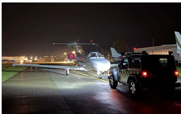
Hierbei muss darauf geachtet werden, dass nur das Abblendlicht - und nicht aus Versehen das Fernlicht - verwendet wird, da sonst anfliegender und rollender Verkehr geblendet werden könnte.
